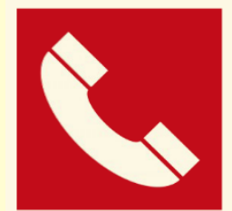
Teléfono para la lucha contra incendios
